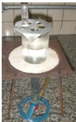
Figura 1.3. Técnica de aquecimento e evaporação usando banho-maria.
